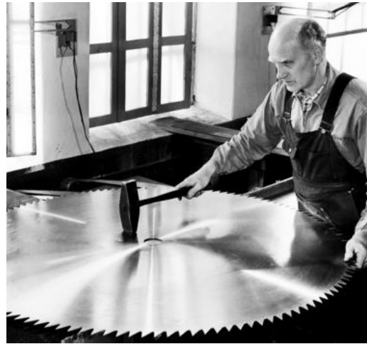
En yrkeskategori på Stridsberg och Biörck var dåtidens rockstjärnor inom sågbladstillsverkarindustrin, nämligen de som hade hand om riktningen av bladen. Med millimeterprecision slog de ner hammaren på det roterande bladet och den så viktiga balansen i bladet var ett faktum.
